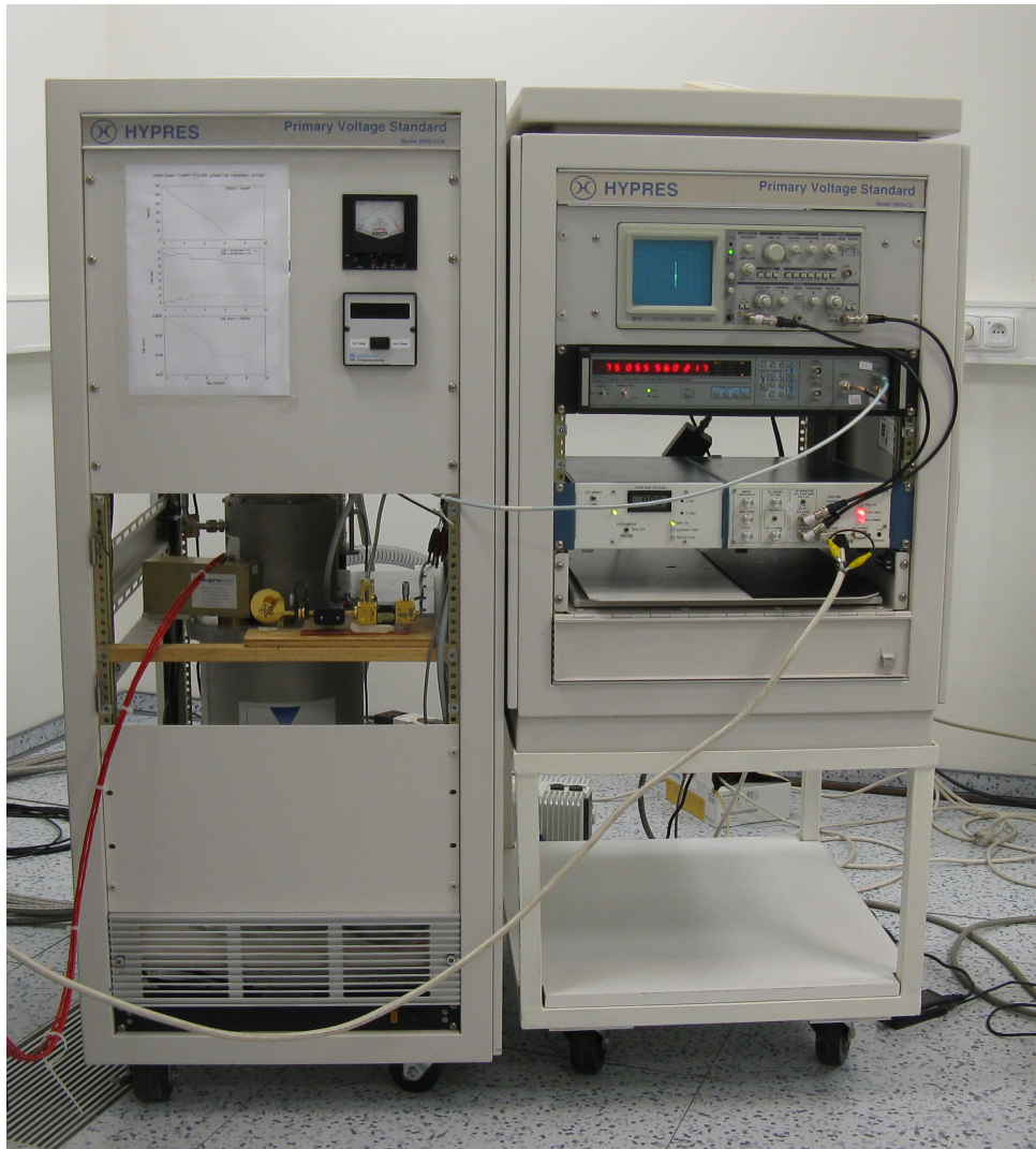
Obrázek 8: Fotografie kvantového etalonu stejnosměrného napětí ČMI. V levé části je vakuová nádoba s chladícím zařízením a Josephsonovým čipem, v pravé části je osciloskop s voltamperovou charakteristikou Josephsonova čipu pro jeden kvantový stav, čítač a řídicí zdroj.
